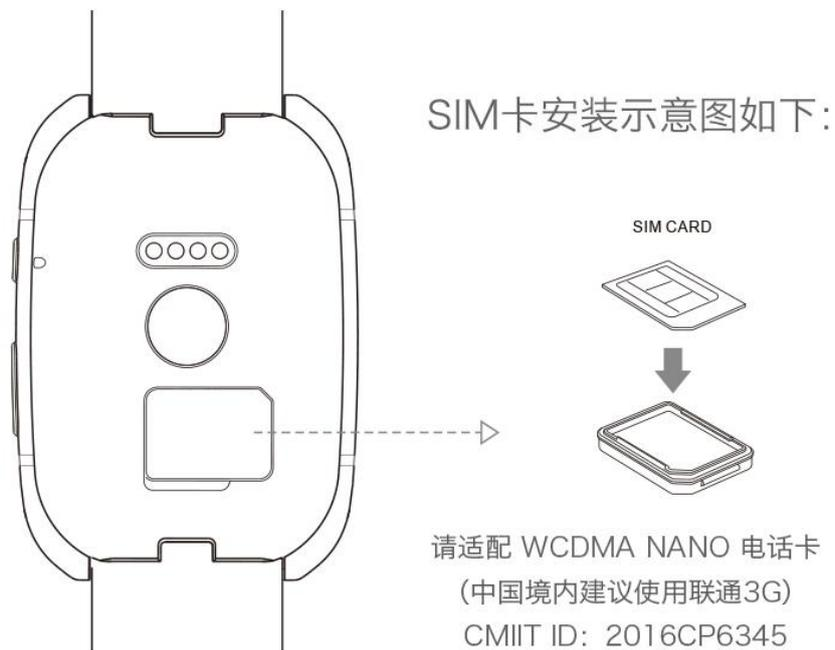
安装电话卡时，请如上图所示先将电话卡放入 SIM 卡盖中，然后将它们一起按入 SIM 卡卡槽中，SIM 卡盖平整即表明安装成功。
